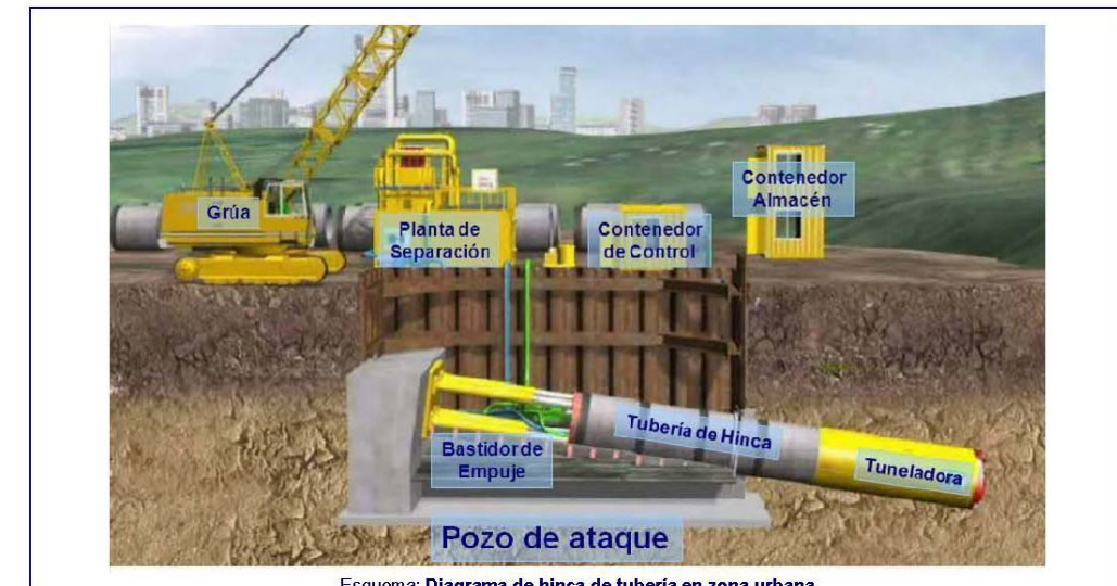
Esquema: Diagrama de hincas de tubería en zona urbana
