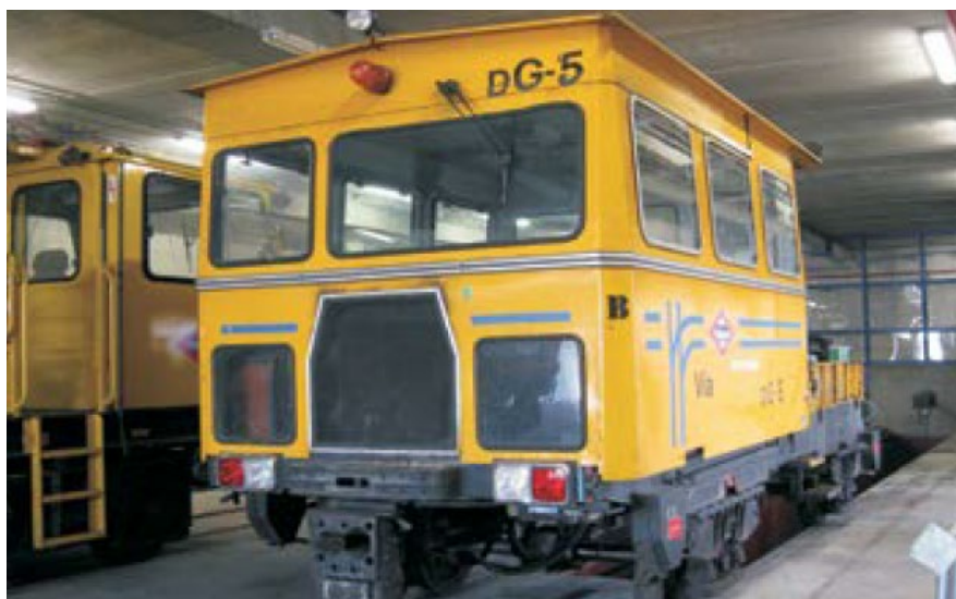
Figura 13. DG-5. Dresina con plataforma DG-5.
