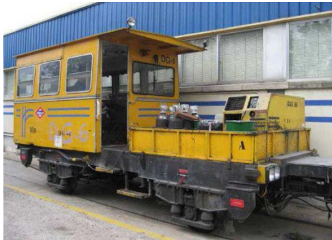
Figura 14. DG-6. Dresina de ejes con plataforma de carga y grúa.
