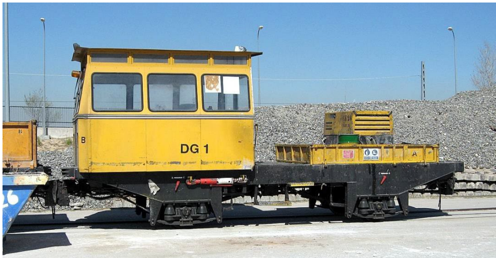
Figura 10. DG-1. Dresina de ejes con plataforma de carga y grúa.
