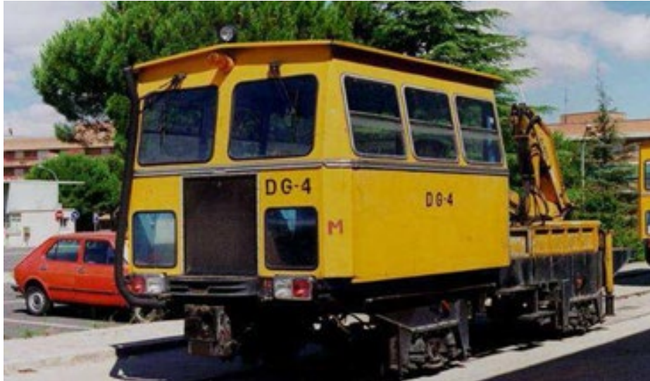
Figura 12. DG-4. Dresina de ejes con plataforma de carga y grúa.
