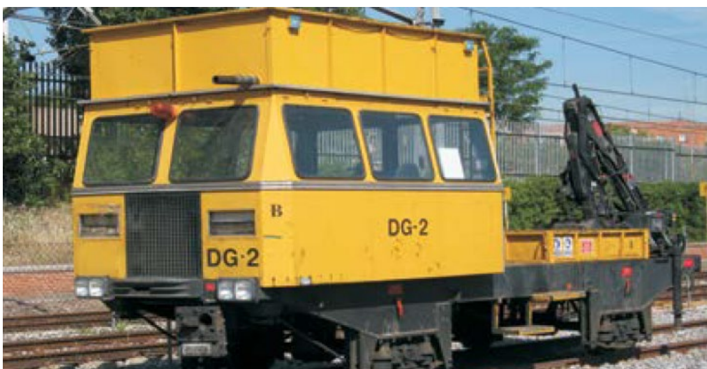
Figura 11. DG-2. Dresina con plataforma y grúa.
