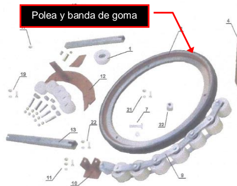
Figura 2. Componentes sistema de tracción
