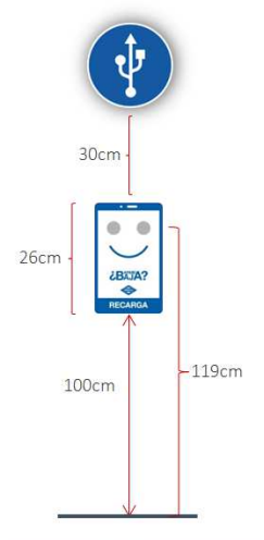
Fig. 2. Croquis de instalación en paramento vertical
