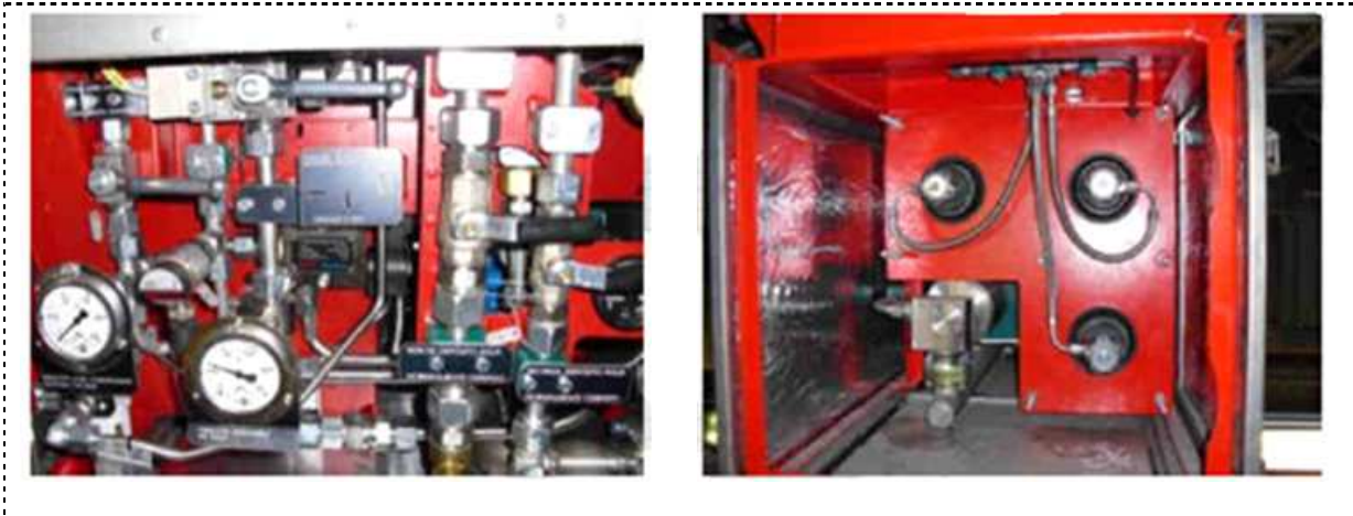
Grupo 6 Fotografías. Cofre SDPI bajo bastidor con botellas
