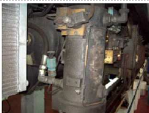
Grupo 4 Fotografías. Torres de Secado bajo bastidor
