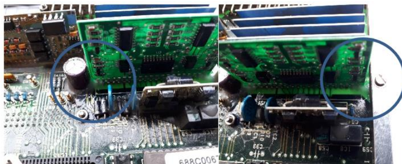
Ilustración 4. Fijación nuevo híbrido.
