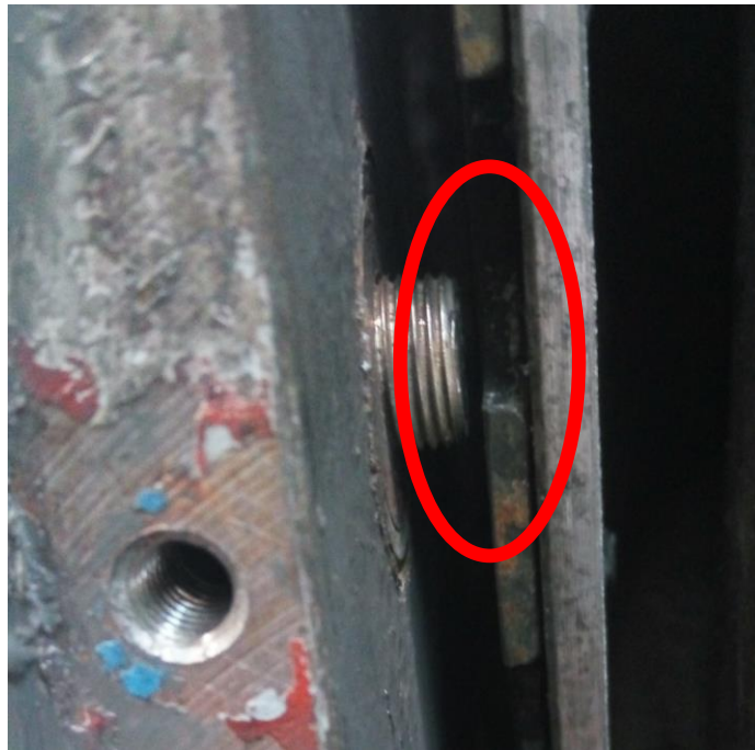
Figura 4. Medición de distancias entre sonda y rueda fónica
