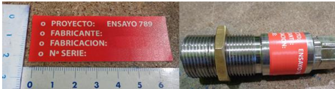
Figura 5. Ejemplo de identificación de las sondas de velocidad
