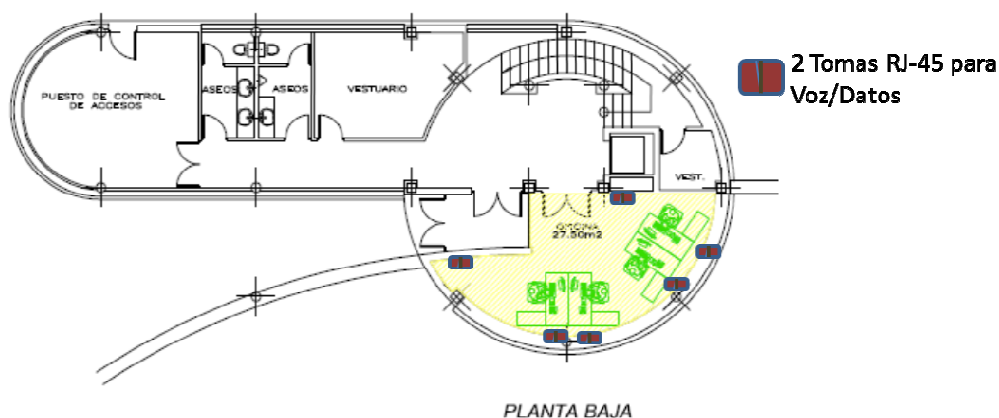
Figura 6. Tomas de voz y datos en la planta baja del Edificio del Jefe de depósito de Laguna.
