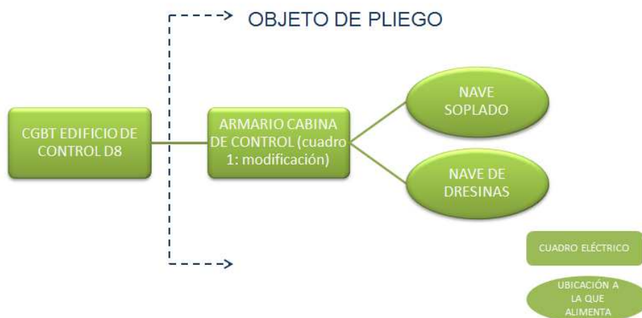
Figura 19: estructura de alumbrado de socorro naves de dresinas.
