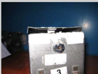
Tapa con deformación posiblemente al arrastrarse tumbada o mal apilamiento
