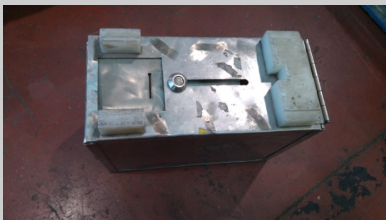
Tapa deformada posiblemente al arrastrarse tumbada o mal apilamiento.
