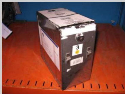
Falta el asa metálica.
