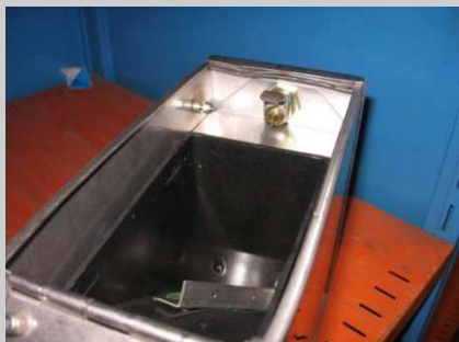
Elementos desmontados y muestras de forzamientos en la zona de cierre.
