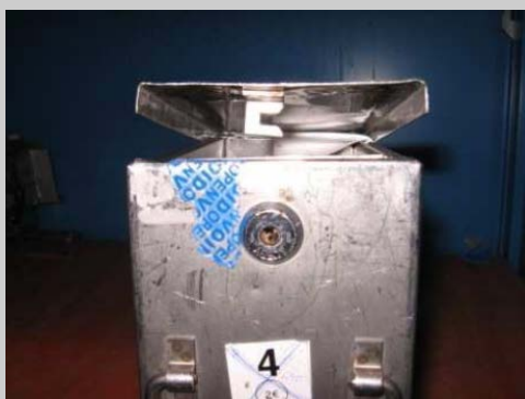
Tapa forzada, presenta deformación en la zona de enclavamiento de la cerradura.
