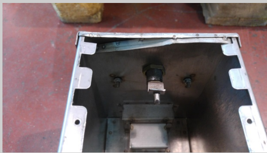
Zona del cierre de la tapa deformada.
