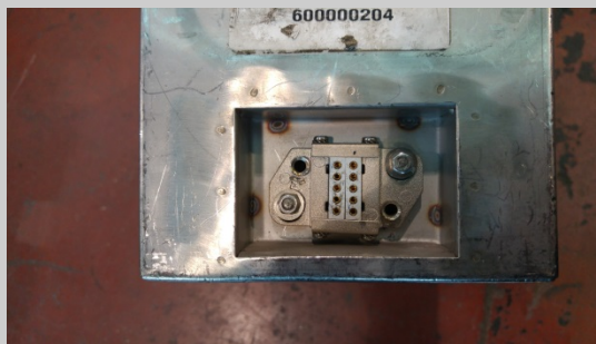
Parte posterior deformada posiblemente al arrastrarse tumbada o mal apilamiento.
