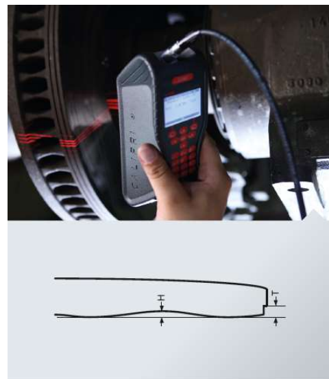
Medición desgaste disco de freno
