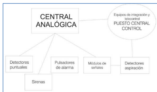
Fig. PCI – Diseño estructurado del sistema de detección de incendios en estación
