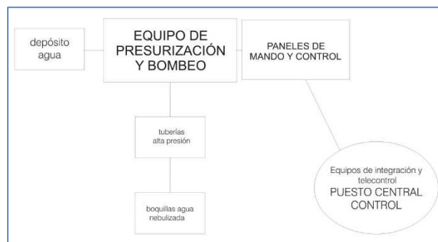
Fig. PCI – Diseño estructurado del sistema de extinción de incendios en estación
