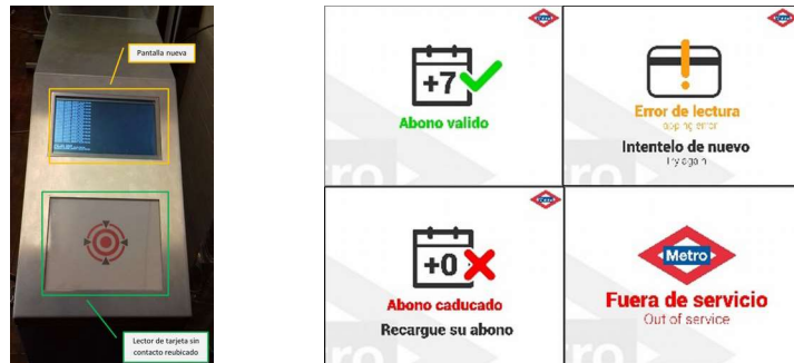
Prototipo pantalla TFT y diseño de interface de usuario
