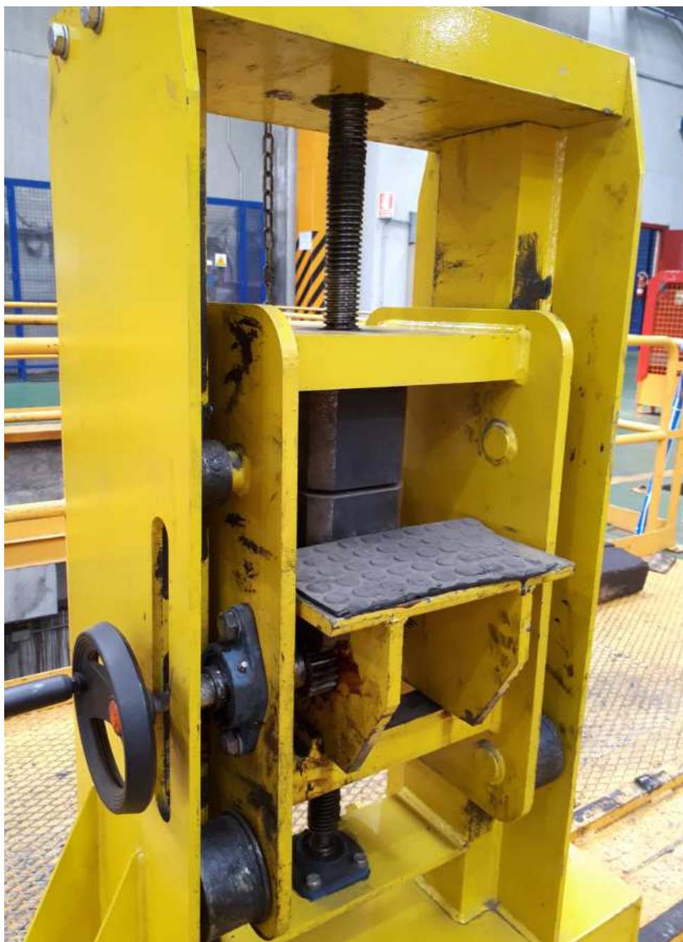
Soporte mesa BB con detalle del usillo de movimiento vertical y uña a la caja.
