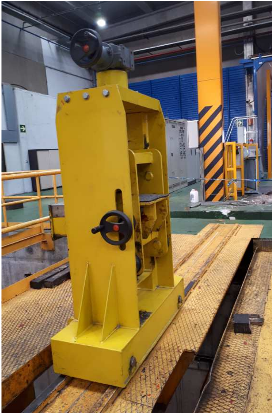
Soporte mesa BB con detalle del desplazamiento del conjunto en carril.
