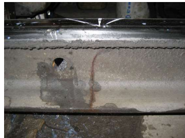
Ilustración 1. Defectos localizados en la pisa del carril
