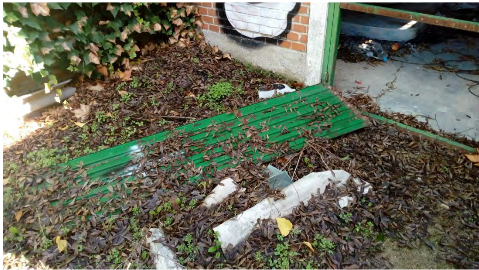
Foto 49 Restos de elementos de fibrocemento
