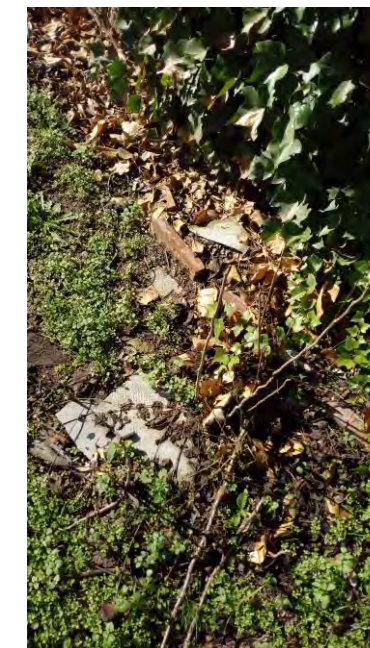
Foto 23 Fragmentos de placas de fibrocemento
