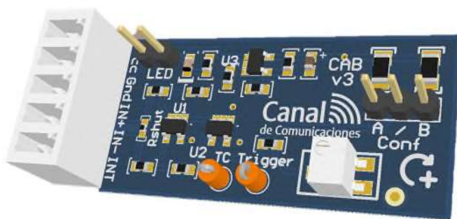
Ilustración 10 - Placa Current Sensor
