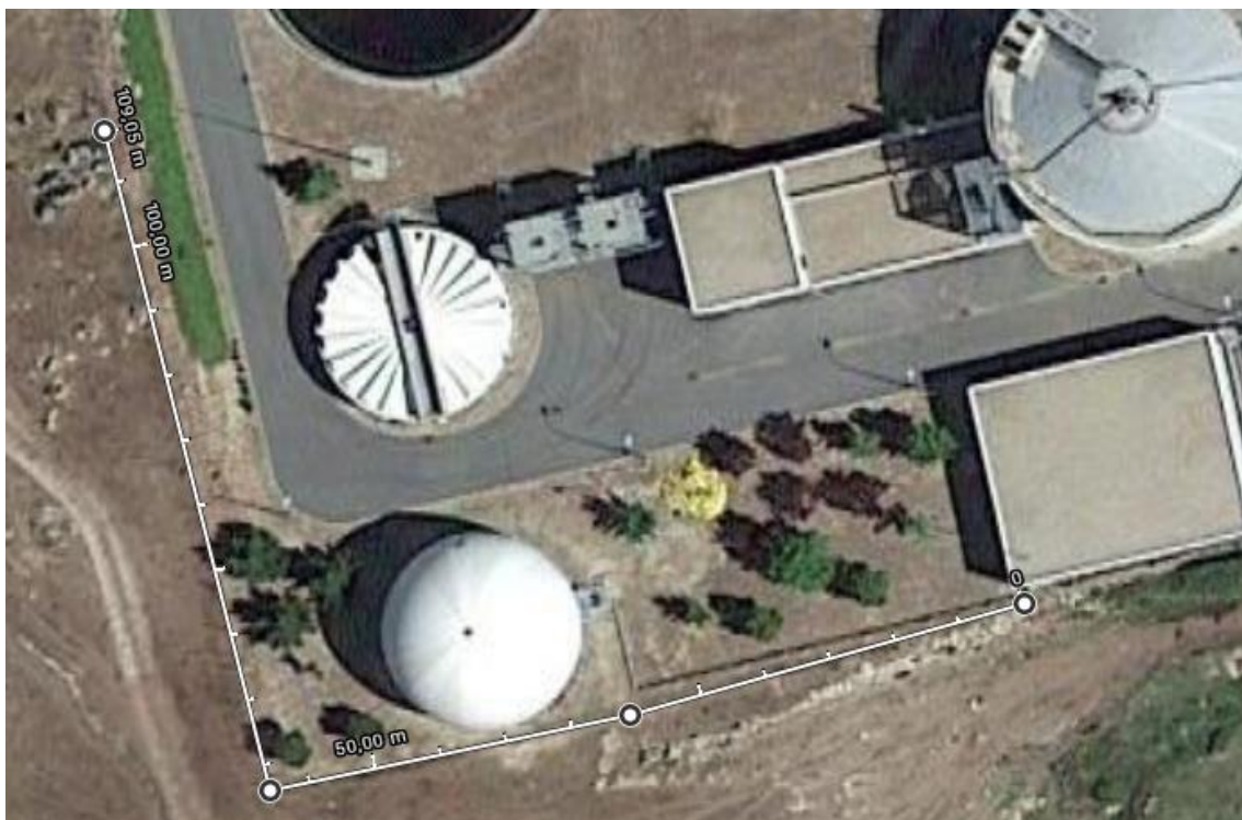
Ilustración 31: Zona de nueva instalación de vallado sobre murete de obra en la EDAR Navarrosillos, retirando el actual vallado
