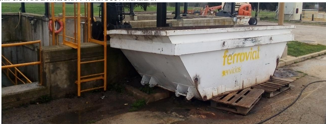
Ilustración 64: Asiento del contenedor de la cuchara bivalva
