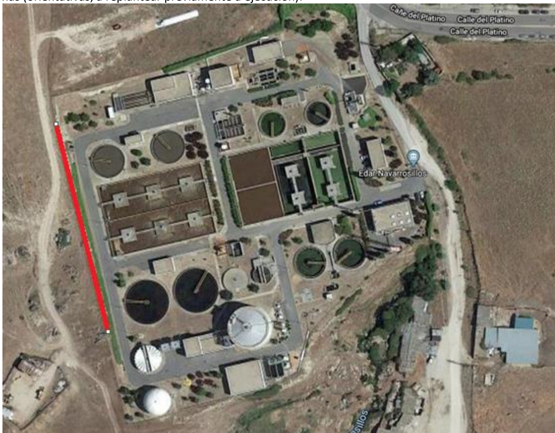
Ilustración 30: Zona del cerramiento de la EDAR Navarrosillos a sustituir malla, parte de ella incluyendo postes
