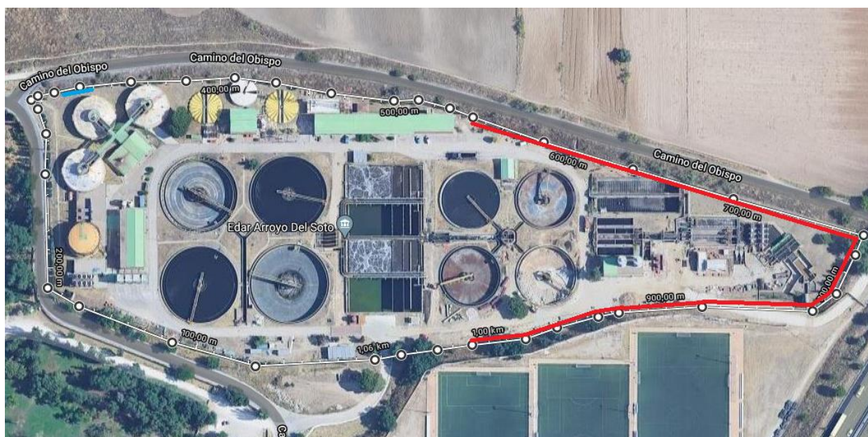
Ilustración 9: Planta de la actuación, con perímetro completo a sustituir. En rojo, zona de instalación de soportes para tubo de desodorización y en azul, tramo de gran reparación de murete.
