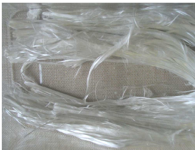
Ilustración 2. Fibras de Amianto
