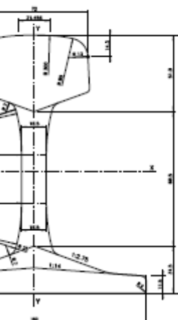
SECCION DE CARRIL 60E1 (UIC60)
