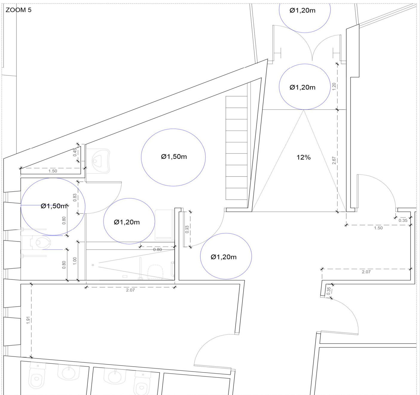
ZOOM 5 - REFORMA DE ASEO-VESTUARIO Y SALIDA DE EMERGENCIA (RAMPA DEL 12% ATENDIENDO A TOLERANCIAS ADMISIBLES).
