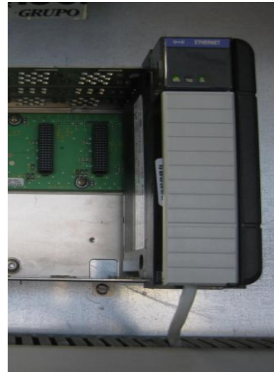
Fotografía 22: Switch y tarjeta Ethernet PLC02
