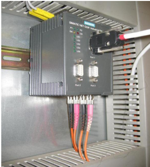
Fotografía 22: Switch y tarjeta Ethernet PLC02
