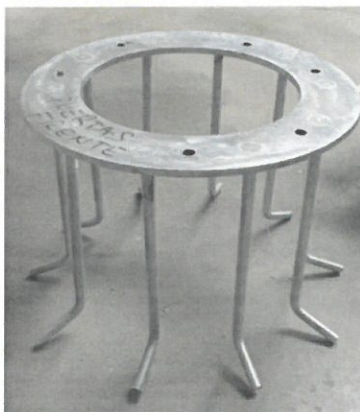
Fotografía 1. Placa base o anclaje con diez pernos roscados.
