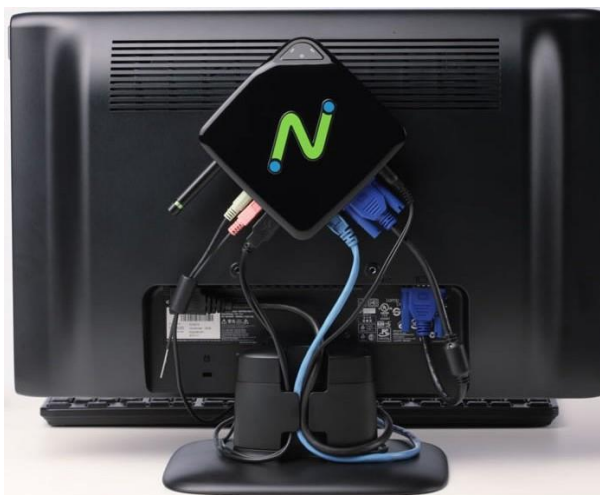
Imagen 1: Instalación de un terminal en la parte trasera de un monitor
