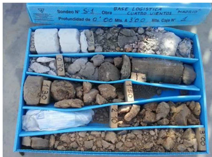
Caja 1 sondeo 1. De 0,00 a 3,0'0 m. Solera de hormigón y rellenos hasta 0,70 m. De 0,70 a 1,30 m Suelo vegetal sobre arena tosquiza.
