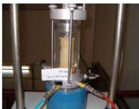
Muestra durante la realización del ensayo triaxial en suelos
