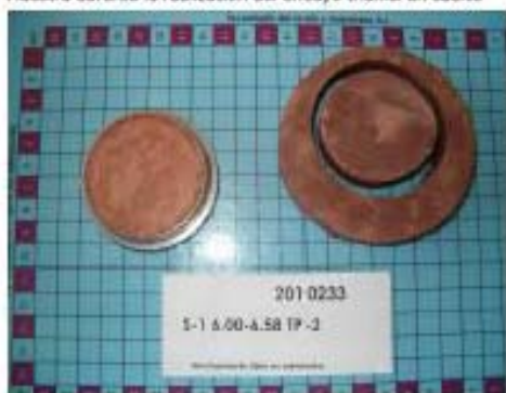
Tallado de muestras de roca-suelo para ensayos de colapso
