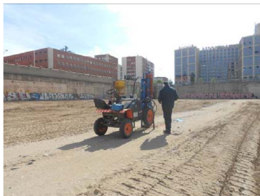
Fig. 9: Vista del Ensayo DPSH P-2. Fondo muro contención de tierras de C/ San Benito esq. C/ de San Aquilino
