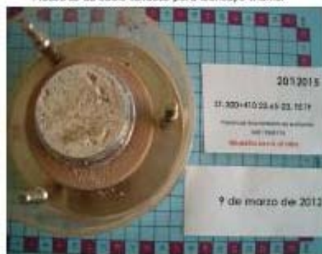
Ensayos de hinchamiento sobre muestra seca al aire durante 7 días
