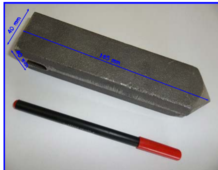
Fig. 7.: Detalle de la puntaza normalizada de uso en los ensayos DPSH
