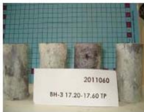
Muestras de suelo talladas para el ensayo triaxial
