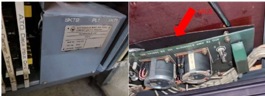
Transmisor ATO de una baliza
