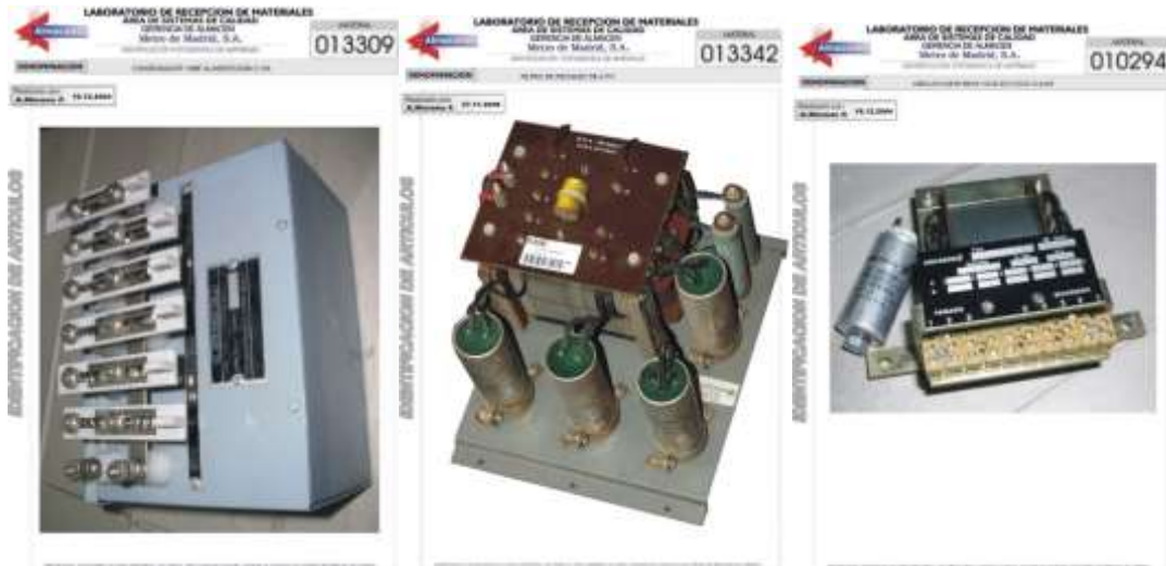
Condensadores de circuitos de vía
