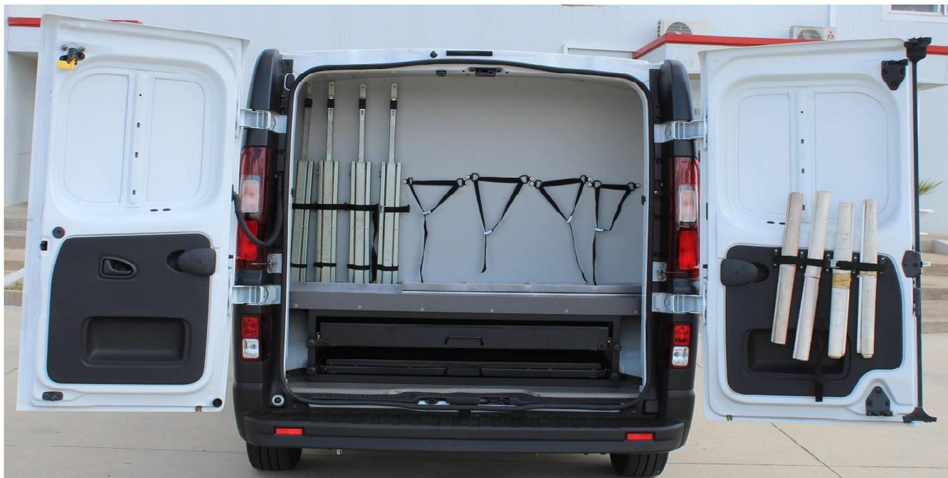
Soportes y correas para fijación de: tetrapodos, calibre de altura, señales, trípodes, rollos, etc
