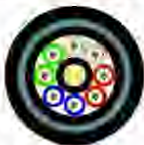
Figura 1. Cable de fibra óptica con protección antirroedores metálica.
