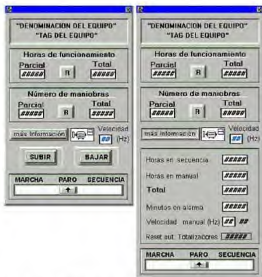
Ilustración 31- Ejemplo de motor con pulsadores de subir y bajar consigna de velocidad.
