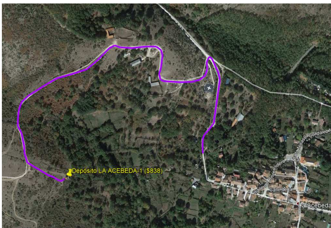
Ilustración 20. Línea morada representa el Tramo de acometida eléctrica necesario en el Depósito Acebeda 1 (Fuente: propia).
