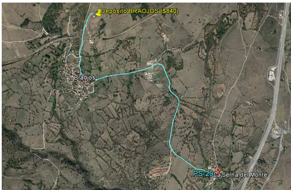
Ilustración 17. Línea azul representa el Tramo de fibra óptica necesario para comunicar el Depósito Braojos (Fuente: propia).
