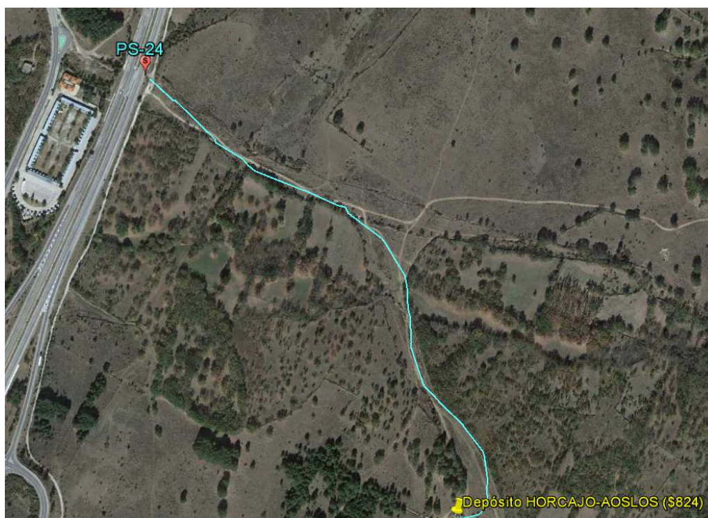
Ilustración 1. Línea azul representa el Tramo de fibra óptica necesario para comunicar el Depósito Horcajo de la Sierra – Aoslos (Fuente: propia).
