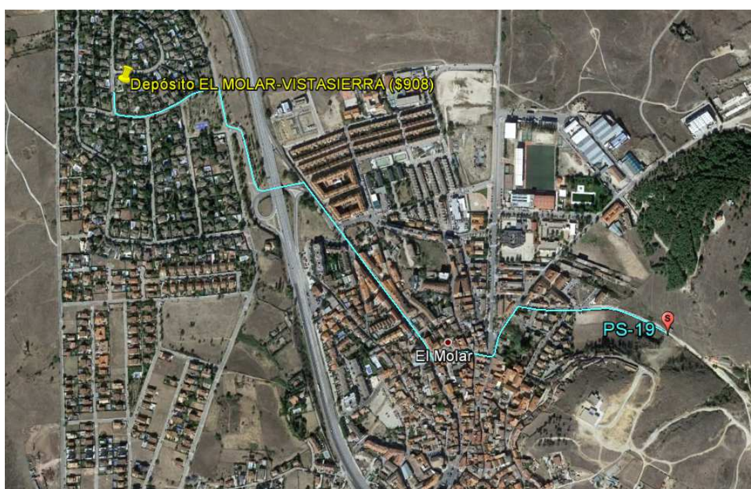
Ilustración 141. Línea azul representa tramo de fibra necesario para comunicar Depósito de Molar 1 (Fuente: propia).
