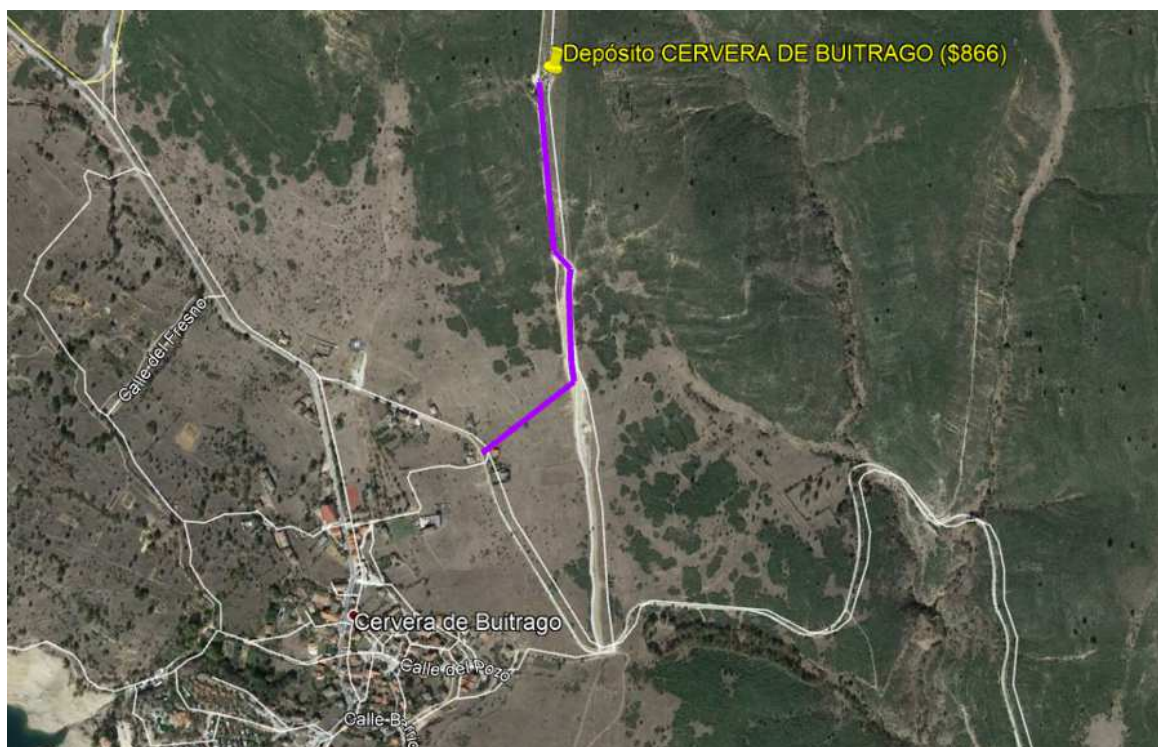
Ilustración 82. Línea morada representa el Tramo de acometida eléctrica necesario en el Depósito de Cervera de Buitrago (Fuente: propia).
