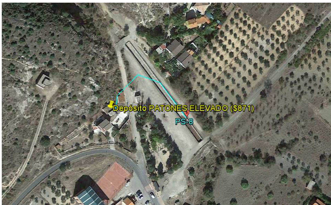
Ilustración 86. Línea azul representa el Tramo de fibra óptica necesario para comunicar el Depósito de Patones Elevado (Fuente: propia).
