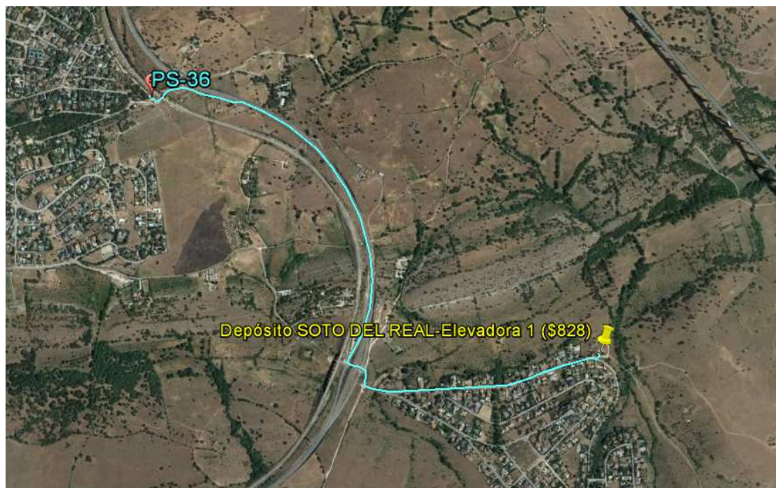
Ilustración 130. Línea azul representa tramo de fibra necesario para comunicar el depósito de Soto del Real Elevadora 1 (Fuente: propia).
