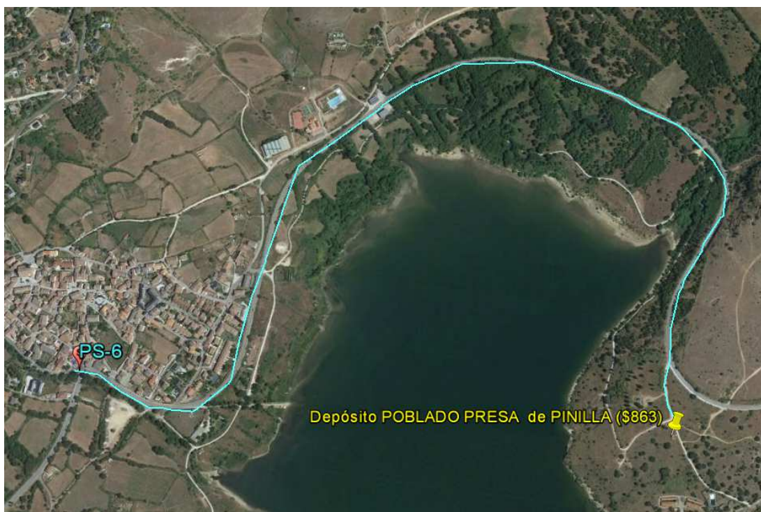
Ilustración 75. Línea azul representa el Tramo de fibra óptica necesario para comunicar el Depósito de Pinilla Poblado con PS6 (Fuente: propia).
