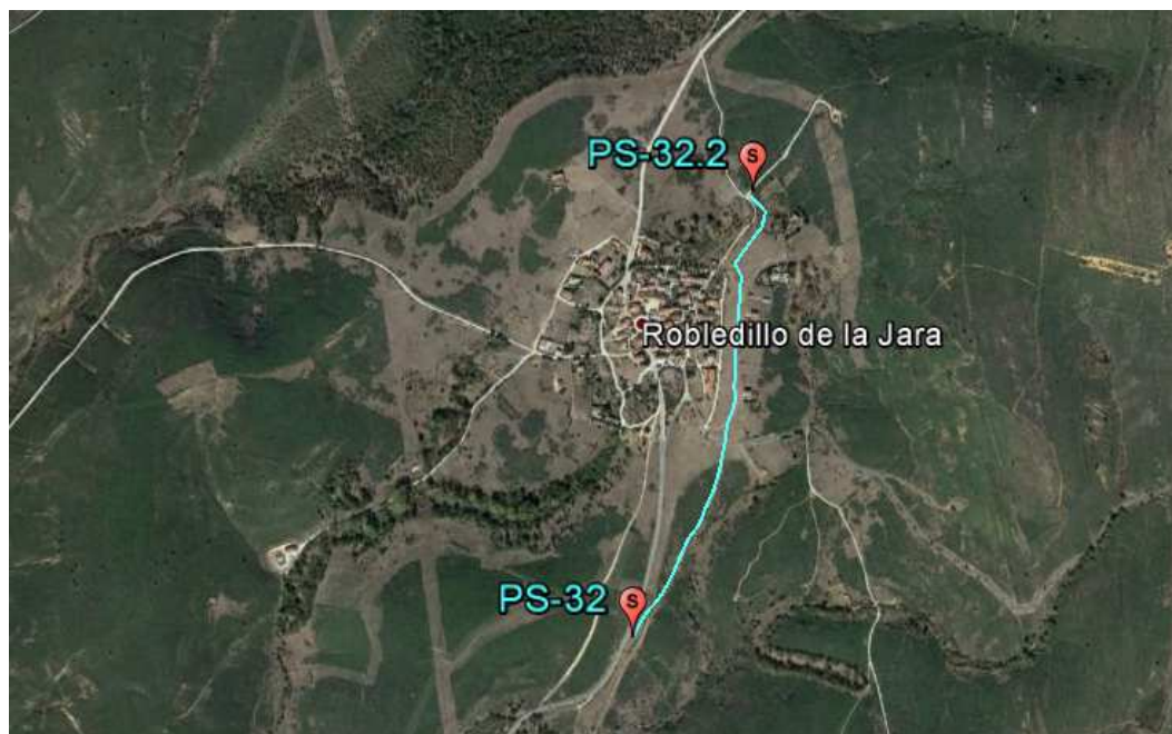
Ilustración 59. Línea azul representa el Tramo de fibra óptica necesario para comunicar el PS32 con el PS32.2 (Fuente: propia).
