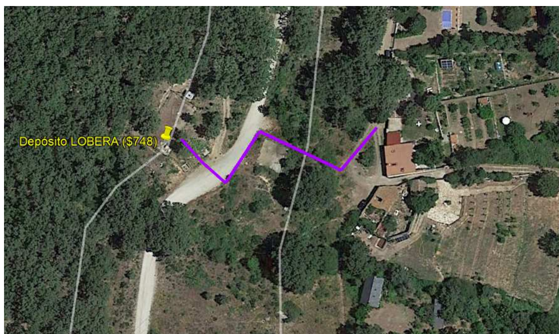
Ilustración 122. Línea morada representa el Tramo de acometida eléctrica necesario en el Depósito de Lobera (Fuente: propia).
