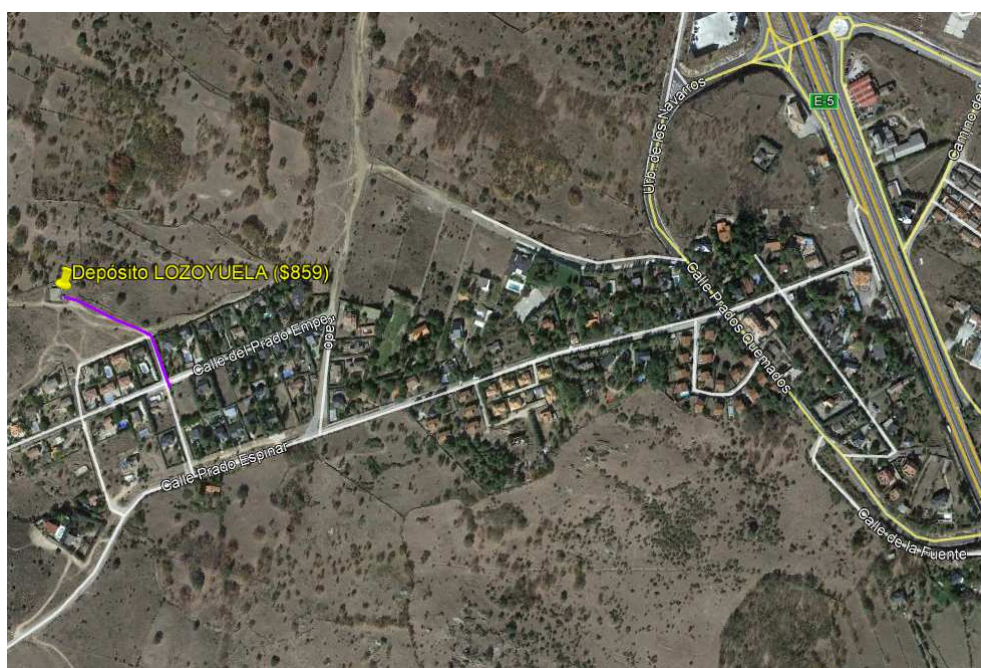
Ilustración 63. Línea morada representa el Tramo de acometida eléctrica necesario en el Depósito de Lozoyuela (Fuente: propia).
