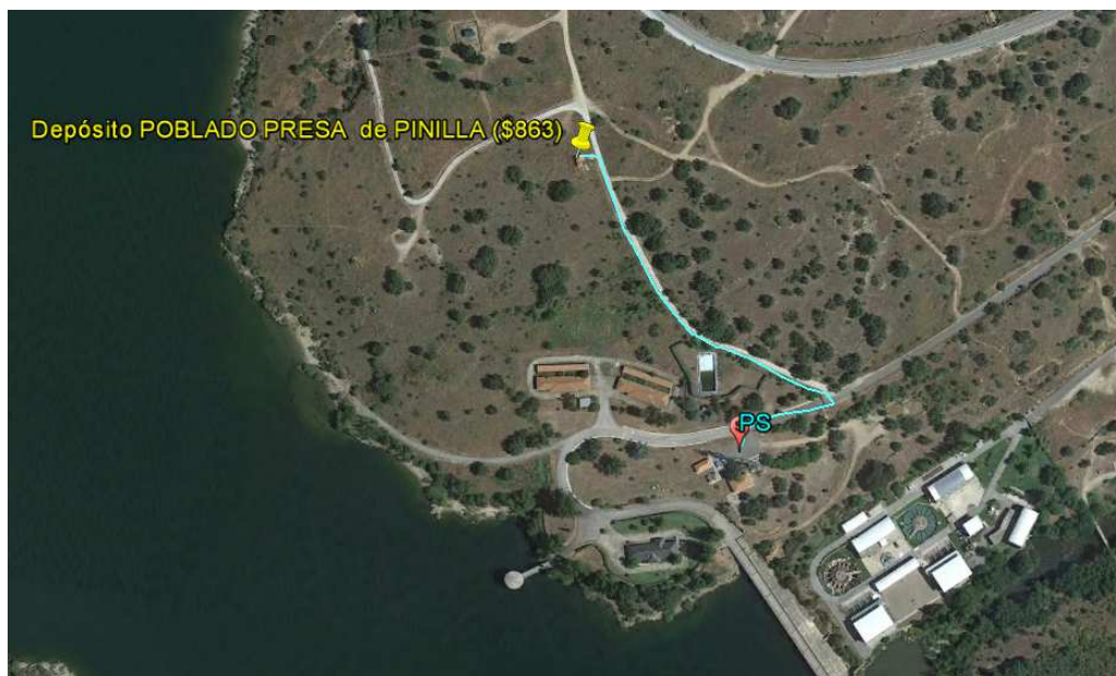
Ilustración 72. Línea azul representa el Tramo de fibra óptica necesario para comunicar el Depósito de Pinilla Poblado (Fuente: propia).
