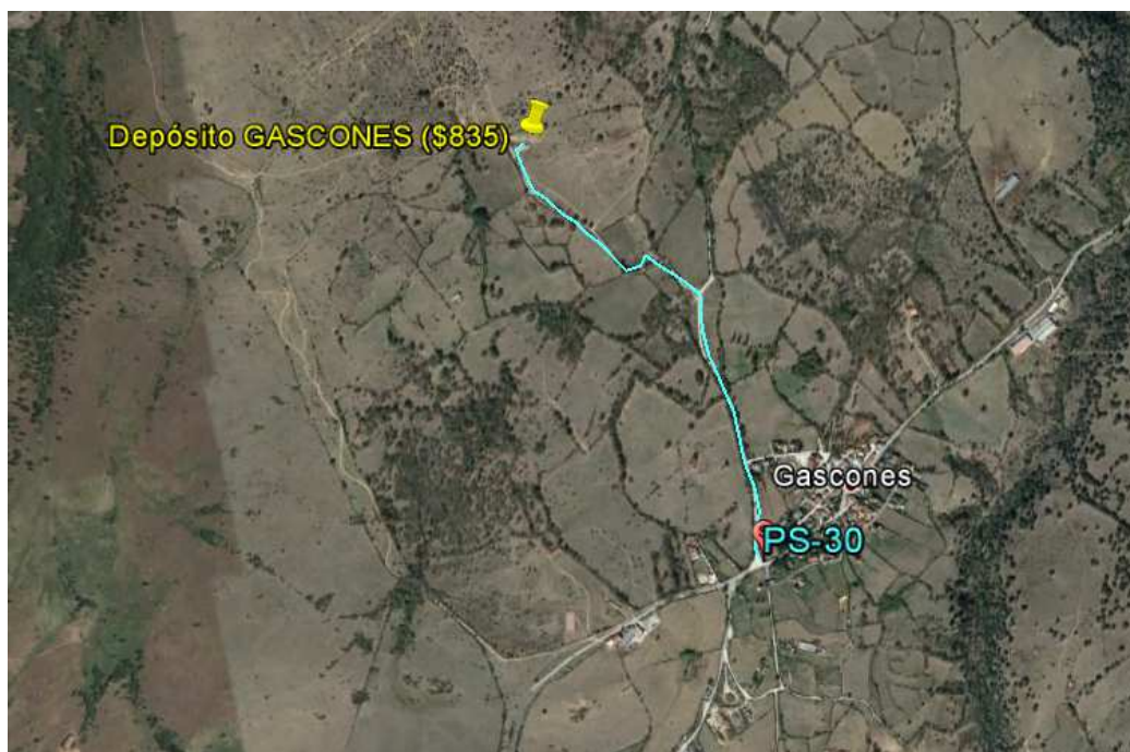
Ilustración 27. Línea azul representa el Tramo de fibra óptica necesario para comunicar el Depósito de Gascones (Fuente: propia).
