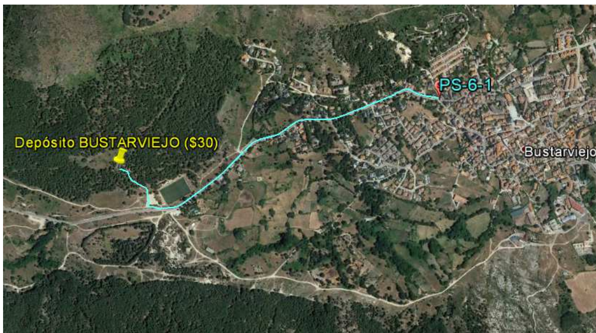
Ilustración 91. Línea azul representa el Tramo de fibra óptica necesario para comunicar el Depósito de Bustarviejo (Fuente: propia).
