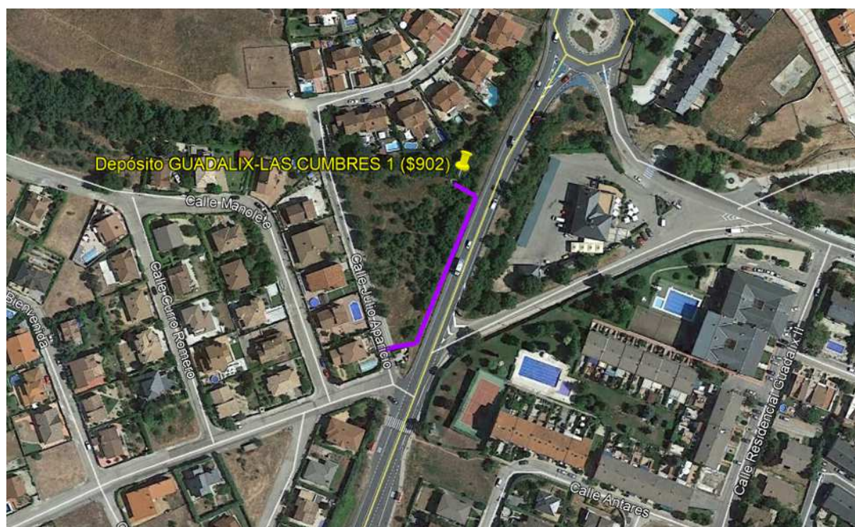
Ilustración 116. Línea morada representa el Tramo de acometida eléctrica necesario en el Depósito de Las Cumbres 1 (Fuente: propia).
