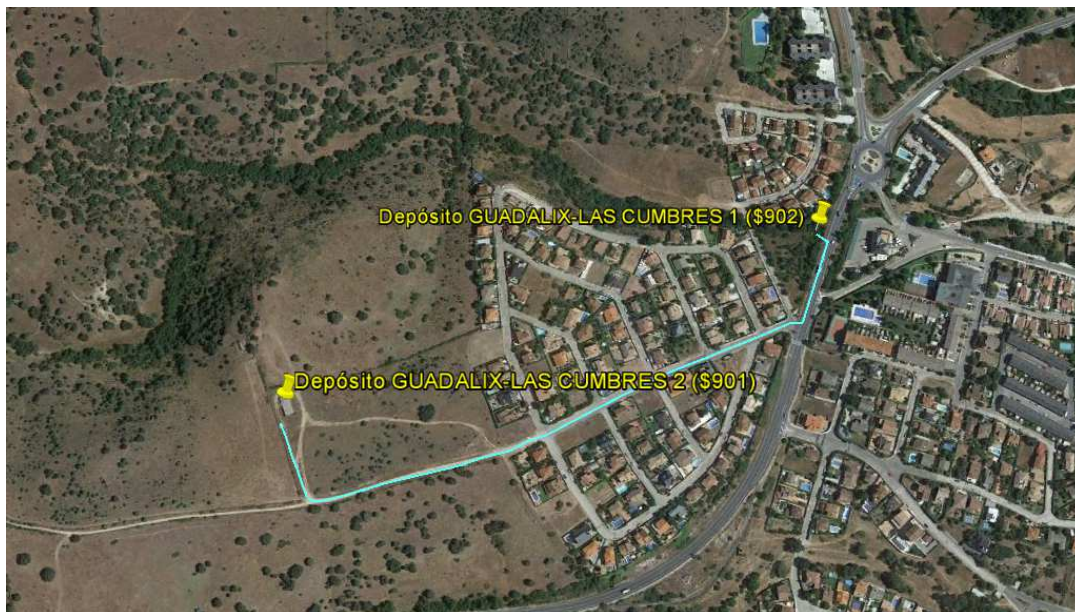
Ilustración 113. Línea azul representa tramo de fibra necesario para comunicar Depósito Las Cumbres-2 (Fuente: propia).
