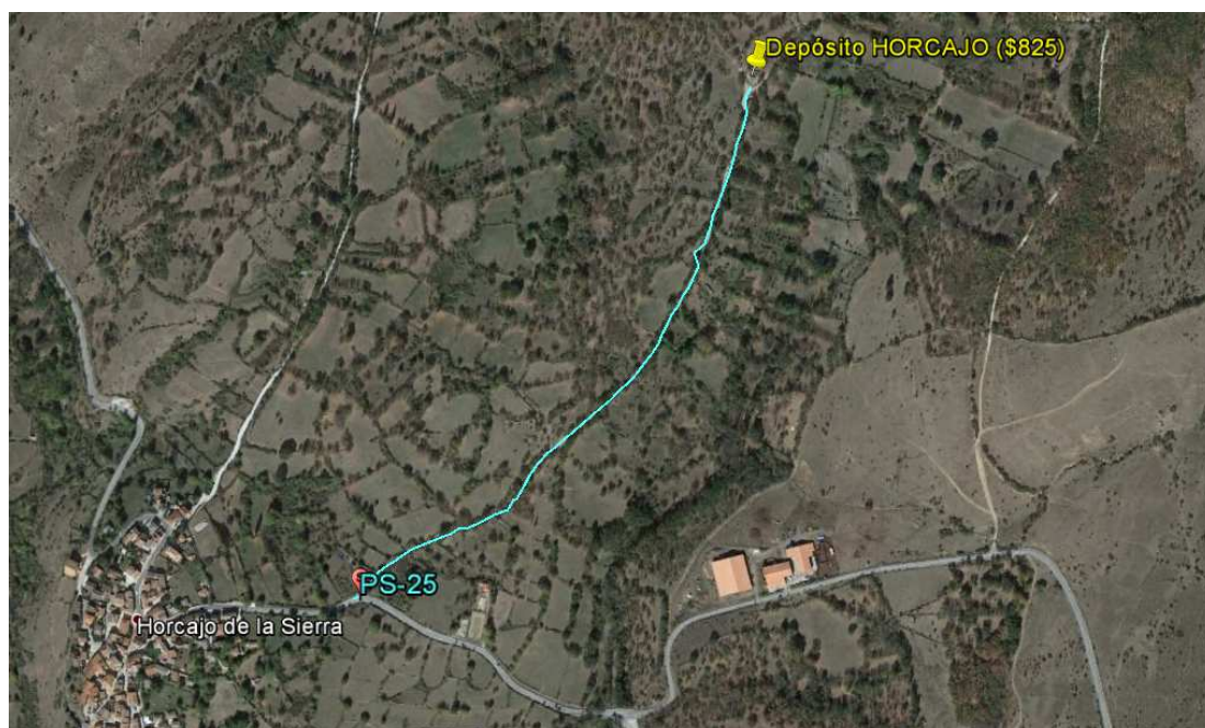
Ilustración 4. Línea azul representa el Tramo de fibra óptica necesario para comunicar el Depósito Horcajo de la Sierra (Fuente: propia).
