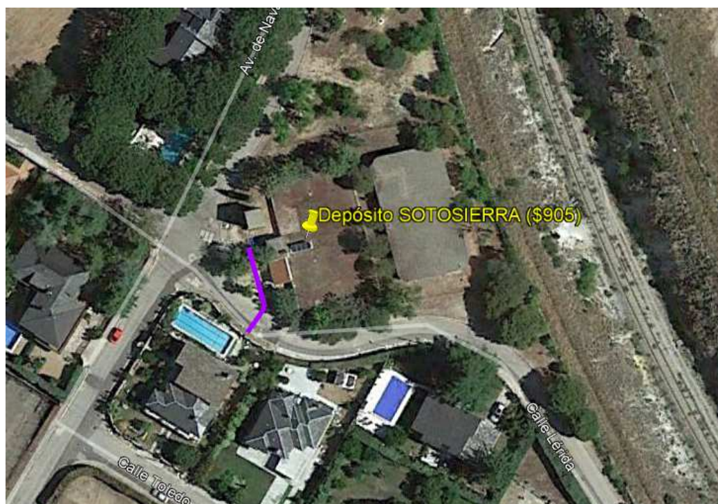
Ilustración 133. Línea morada representa el Tramo de acometida eléctrica necesario en el Depósito de Sotosierra (Fuente: propia).
