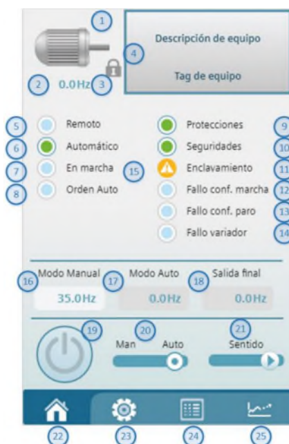
Ilustración 8. Ejemplo de pantalla para diálogo del motor y selector manual-automático
