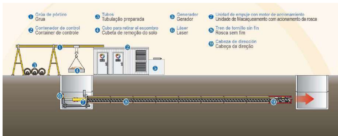
Figura 4. Perforación horizontal mediante tornillo "sinfin".
