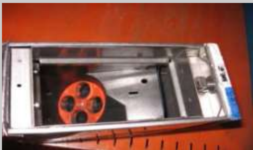
Deformación en parte posterior que presenta rotura del embudo (baquelita).
