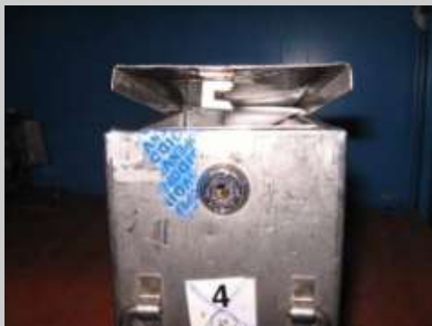
Tapa forzada, presenta deformación en la zona de enclavamiento de la cerradura.
