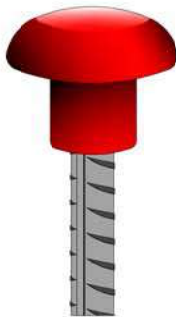
DETALLE PROTECCIÓN ARMADURA " TIPO SETA "
