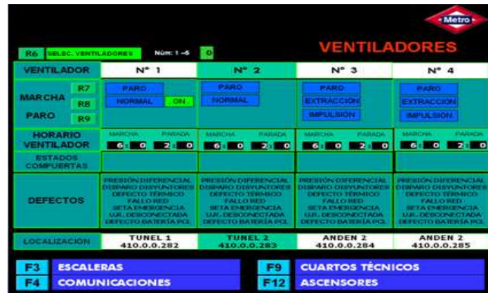
Figura 10. Ejemplo de SCADA local para el control de la ventilación centralizada en una estación de Metro.
