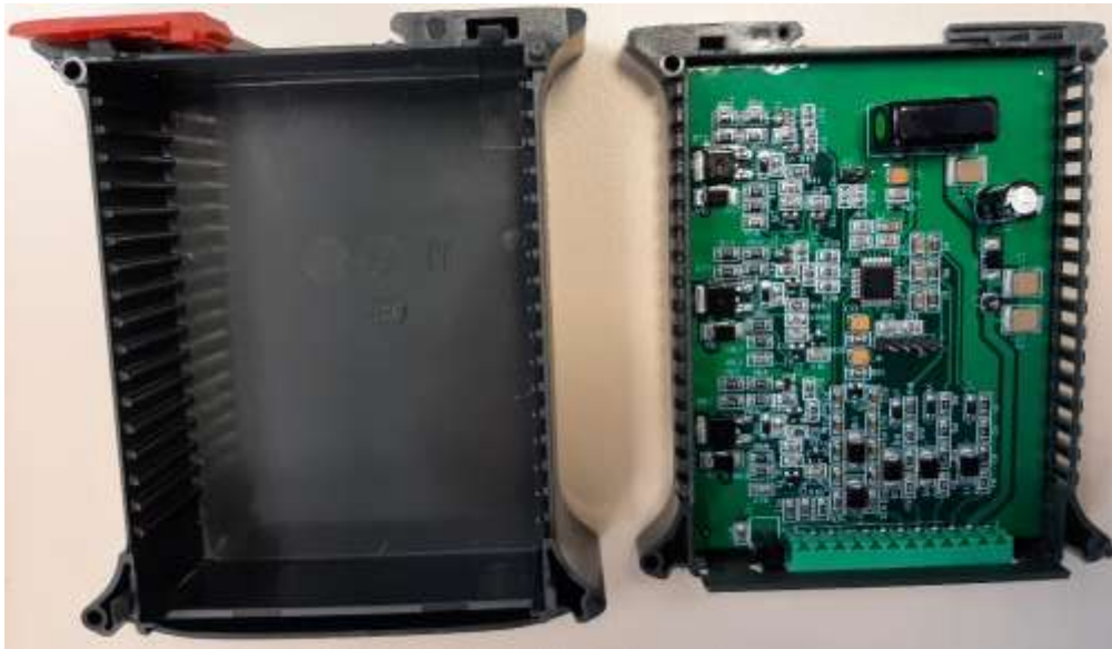
Caja y tarjeta electrónica de control para aviso acústico y óptico en apertura/cierre de puertas TE1902CMP00A (prototipo)
