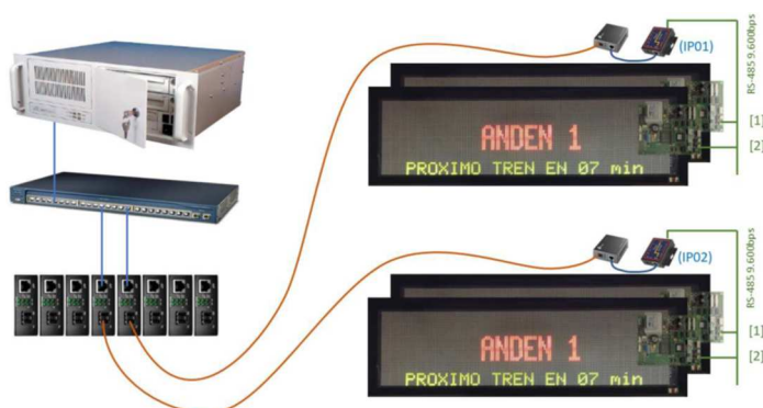
Figura 3 Diagrama de Conexión de Teleindicadores LED de andén con comunicación por TCP/IP
