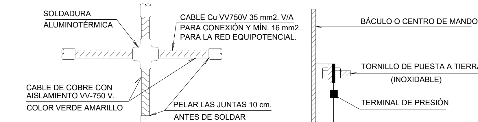
DETALLE DE SOLDADURA DE DERIVACIÓN
