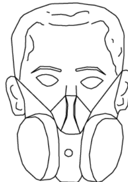
Máscara con filtros recargables. (Según EN 140 y EN 141)
