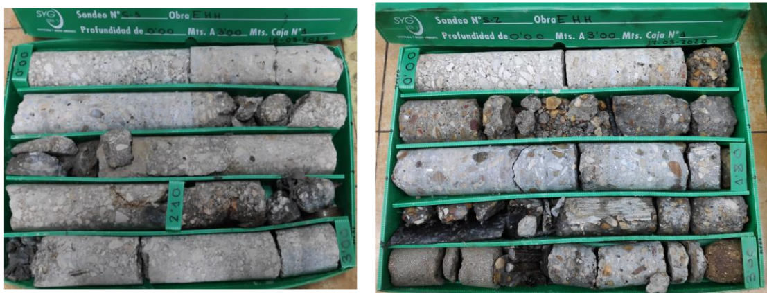
Figura nº 19. Vista de los testigos de hormigón y mortero de relleno de plataforma y losa de fondo en los sondeos S-1 y S-2
