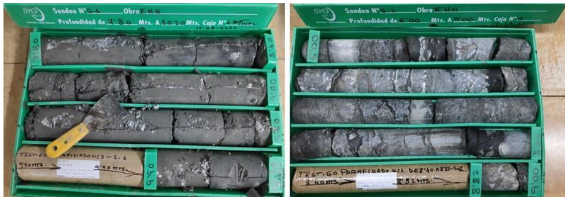
Figura nº 17. Vista de las margas y limos yesíferos /izquierda) y los niveles inferiores de textura rocosa (derecha). S-1
