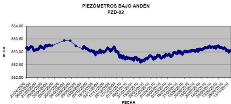
Figura nº 30. Niveles piezométricos del piezómetro de cuerda vibrante PZD -02, años 2009-2010
