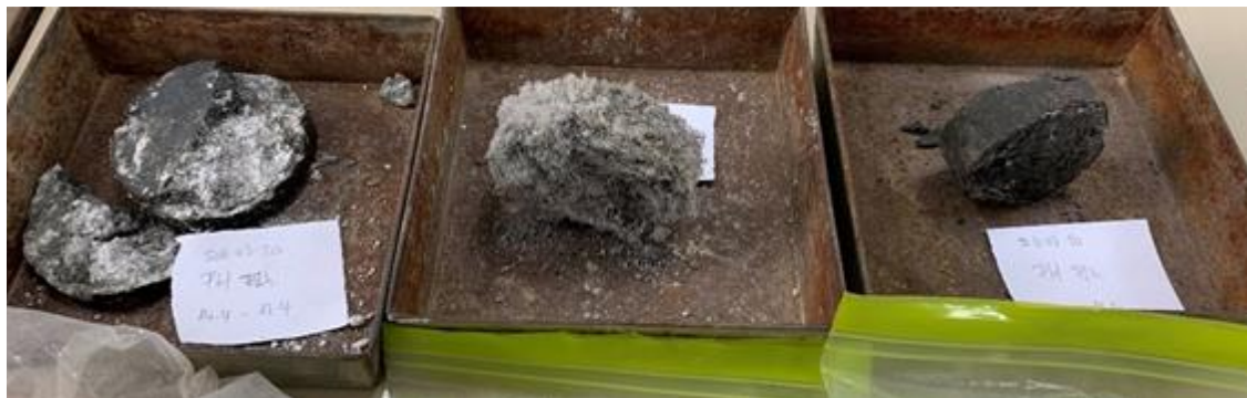
Figura nº 18. Desechado de muestras tomadas en los sondeos realizados sobre la plataforma de vías en el interior de la Estación. Se aprecia la diferente naturaleza del terreno especialmente por el distinto tipo de sales y su concentración respecto a las margas.
