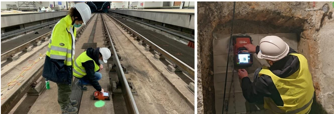
Figura nº 9. Quickscan sobre zona de sondeos y obtención del Radargrama del hormigón de la zona de conexión entre la losa de fondo y los muros bandeja
