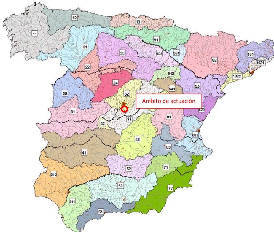
Figura nº 15: Regiones consideradas para la caracterización del coeficiente corrector del umbral de escorrentía
