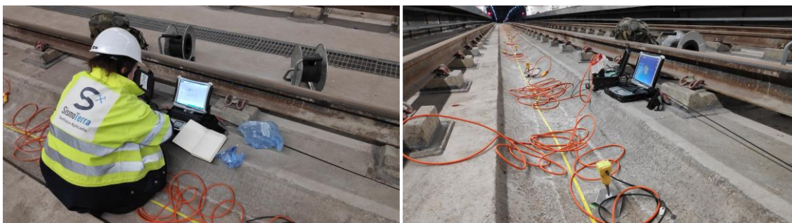
Figura nº 15. Disposición de la tanda de geófonos para detectar las ondas de corte S y de compresión P generadas por golpeo. Perfil realizado en el interior de la Estación en la zona de vías.
