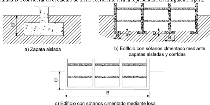
Figura N° 33.- Profundidad D a considerar en la determinación de la presión de hundimiento
