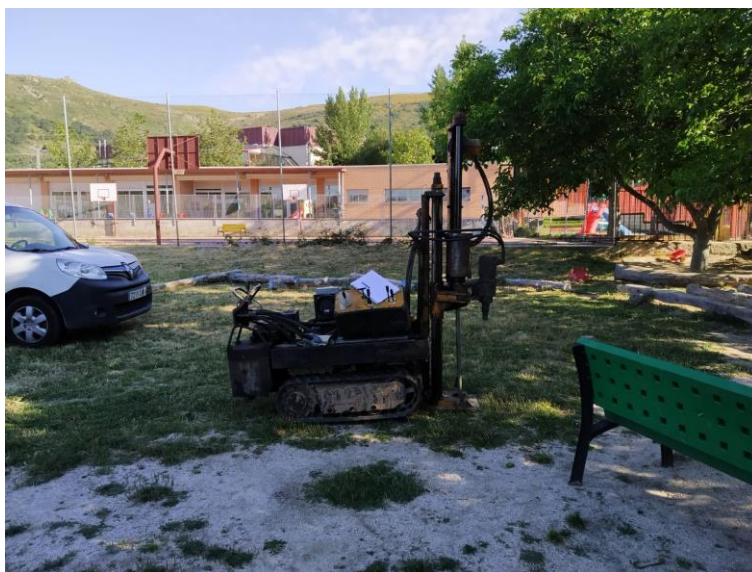
Figura Nº 8.- Imagen de la ejecución del ensayo de penetración dinámica P-02
