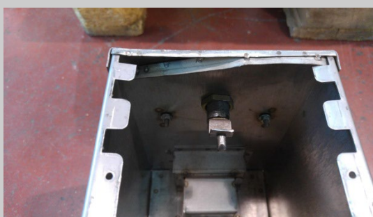
Zona del cierre de la tapa deformada.
