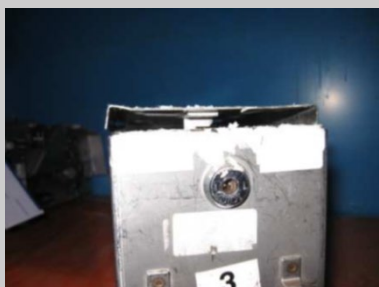
Tapa con deformación posiblemente al arrastrarse tumbada o mal apilamiento
