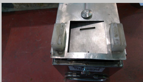
Tapa forzada, presenta deformación en la zona de enclavamiento de la cerradura
