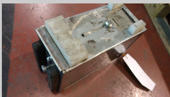
Trampilla de recaudación deformada.
