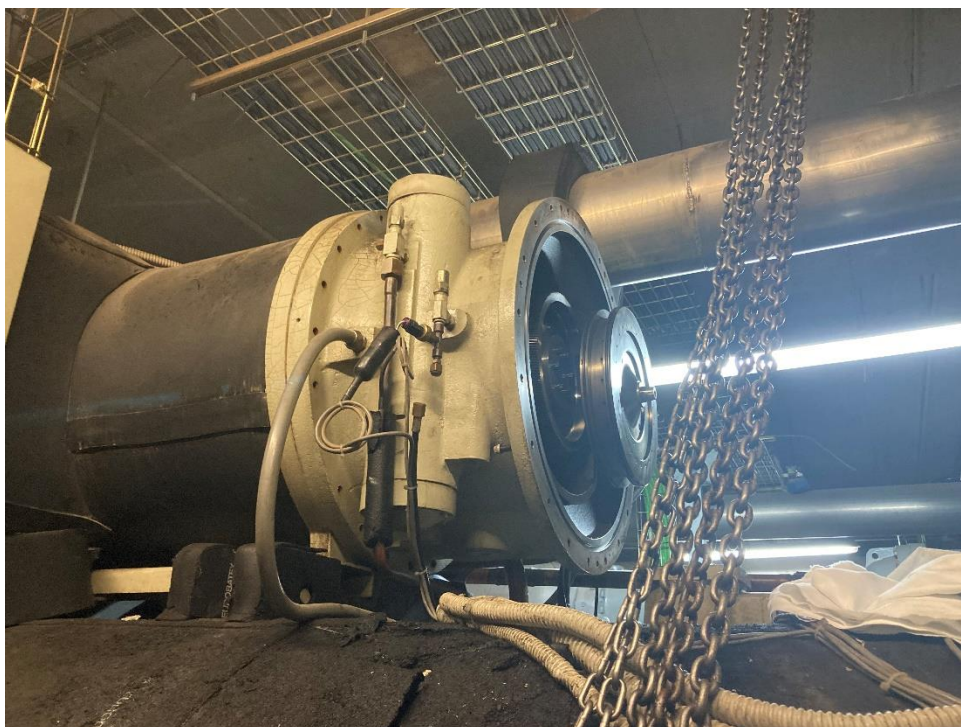
Vistas parciales del compresor centrífugo desmontado y sus acoplamientos.
