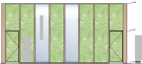
FASE 1. REALIZACIÓN DE CAJÓN LISTO PARA RECIBIR SUPERPOSICIÓN DE TABLERO CURVO (FASE 2) ALZADO S (POSTERIOR) TABLERO OSB
