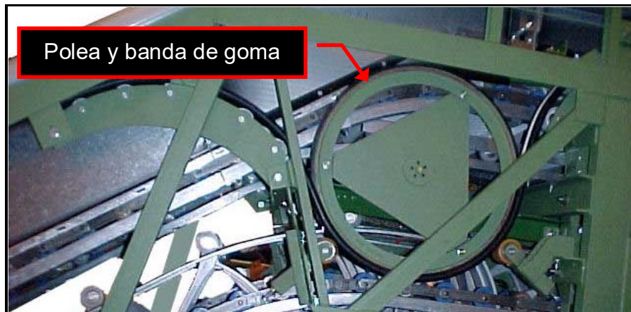
Figura 3. Conjunto sistema tracción pasamanos
