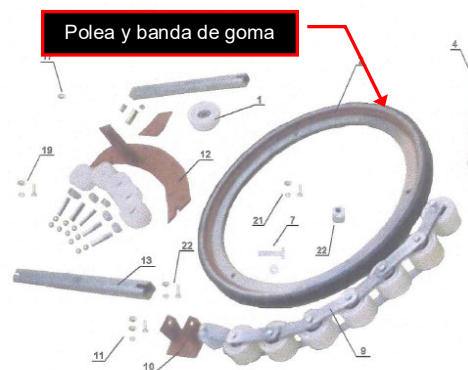
Figura 2. Componentes sistema de tracción
