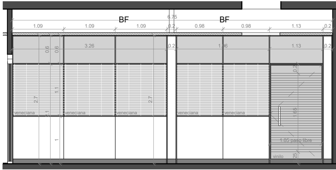
NOMBRE:00_02 UD: 1 C. ESPECIALES: Puerta abatible. Herrajes y manilla aluminio. Cerradura electromagnética con gestión centralizada.
