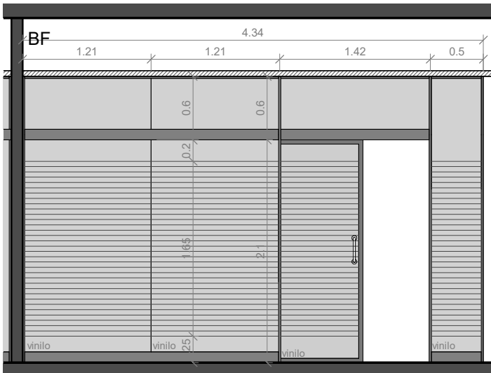
NOMBRE:01_07 UD: 1 C. ESPECIALES: Puerta corredera automática con pulsador de apertura.
