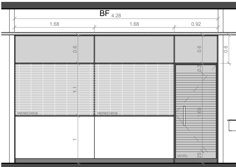
NOMBRE:01_14 UD: 1 C. ESPECIALES: Puerta abatible. Herrajes y manillas de aluminio. Cerradura según Plan de Cierre A41'
