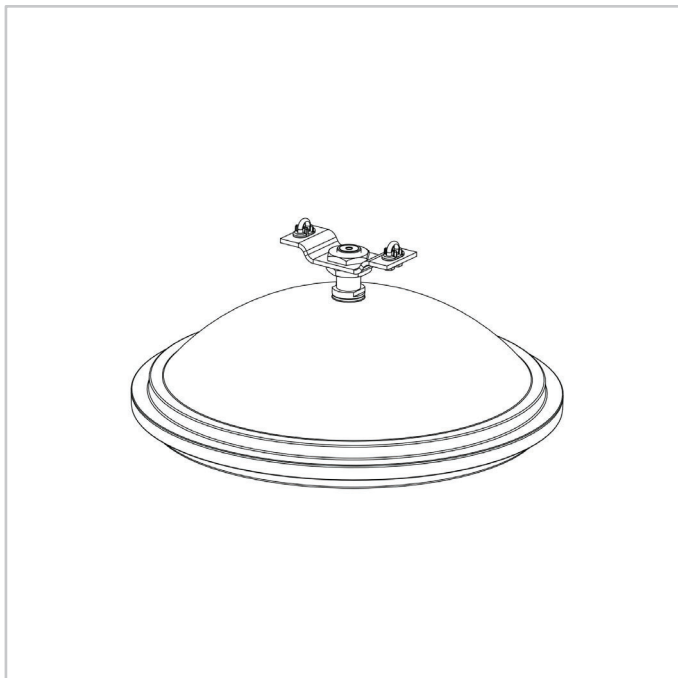
CITEA NG2 | Montaje suspendido con rotula 1" gas macho (S4)
