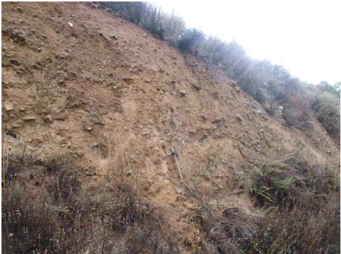
Sondeo S-2 en ejecución, con talud de desmonte en derrubios al fondo. Detalle del talud: arenas arcillosas con cantos.
