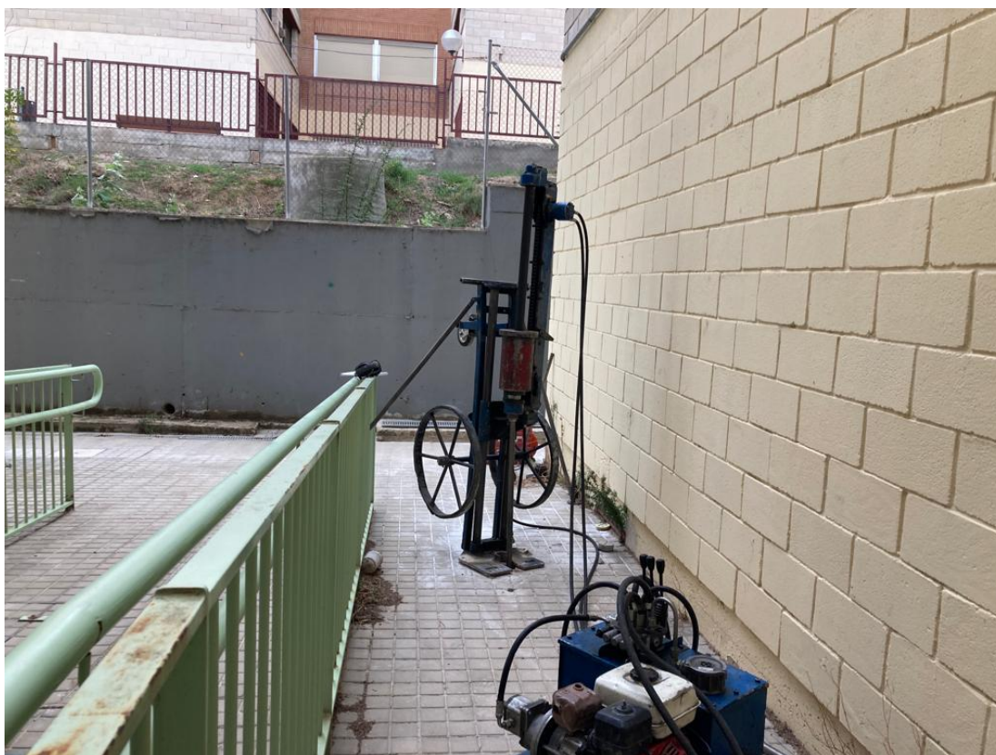
Figura Nº 2.- Trabajos para la realización de la penetración dinámica, tipo DPSH, referida en este documento como P-01.
