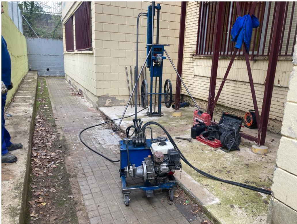
Figura Nº 3.- Trabajos para la realización de la penetración dinámica, tipo DPSH, referida en este documento como P-02.
