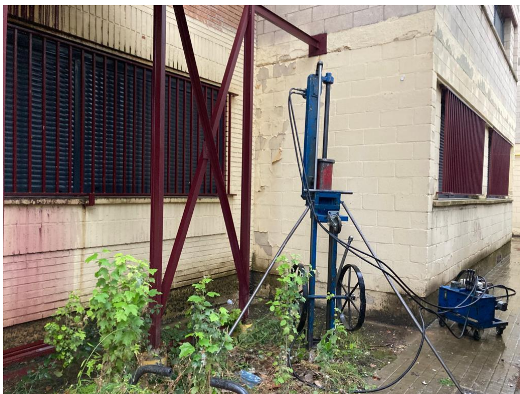
Figura Nº 4.- Trabajos para la realización de la penetración dinámica, tipo DPSH, referida en este documento como P-03.
