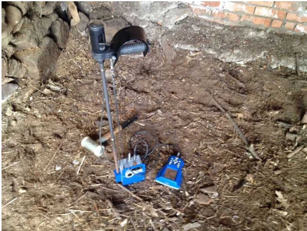
Fotografía 1.- Emplazamiento penetrómetro Panda-1.
