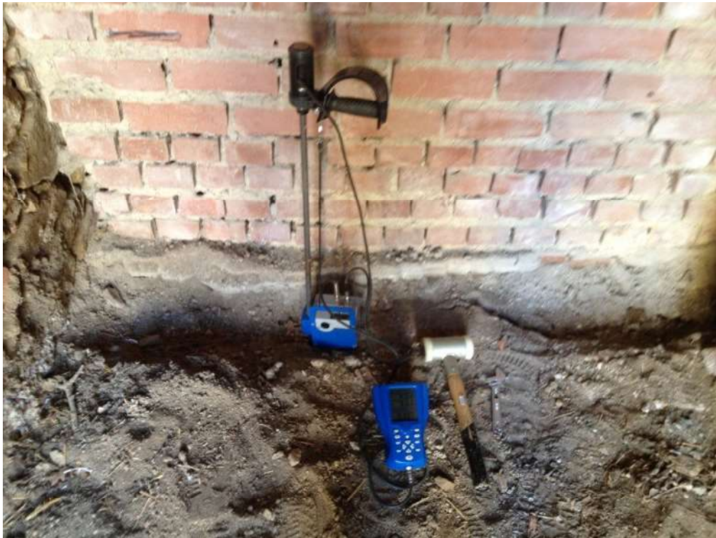
Fotografía 2.- Emplazamiento penetrómetro Panda-2.
