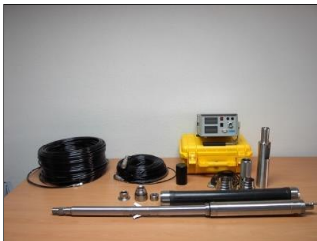
Figura 5. Equipo empleado para la realización de ensayos presiométricos
