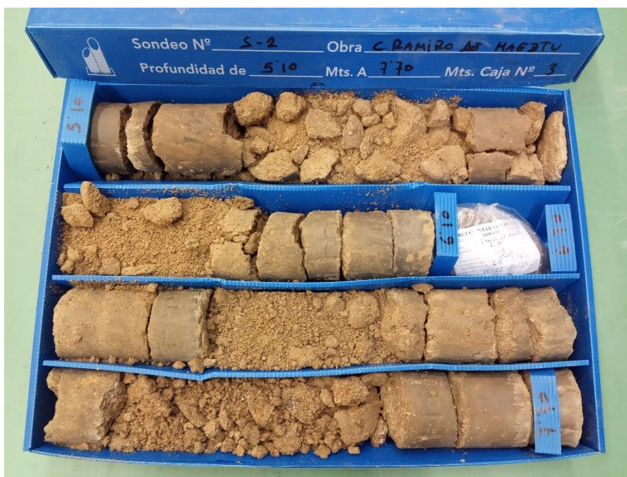
Sondeo S-2, caja 3, de 5,10 m a 7,70 m de profundidad.
